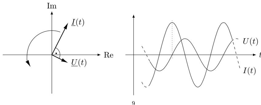
0.5.6. *Induktivität.* Wir betrachten einen Schaltkreis in welchem eine *Spule* mit *Induktivität*  $L$  an eine Wechselspannungsquelle angeschlossen ist.
