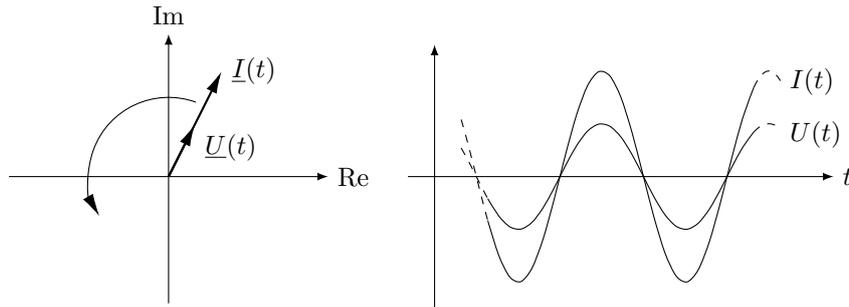
0.5.5. *Kapazität.* Wir betrachten einen Schaltkreis in welchem ein *Kondensator* mit Kapazität  $C$  an eine Wechselspannungsquelle  $I(t)$  angeschlossen ist.
