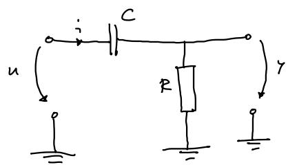
$$\text{Spannung an } R: u_R = \gamma \rightarrow i_R = \frac{\gamma}{R}$$
