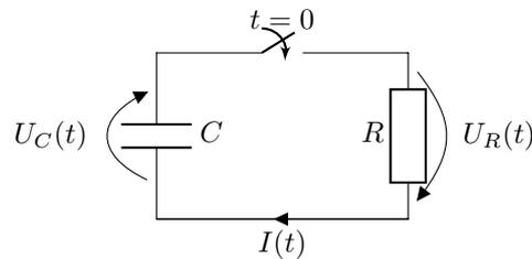
Auf dem Kondensator befinde sich eine Ladung  $Q_0$ . Zum Zeitpunkt  $t = 0$  wird der Schalter geschlossen. Wir interessieren uns für die Ladung  $Q$  auf dem Kondensator in Abhängigkeit der Zeit  $t$ . Die Gesetzmässigkeit zur Beschreibung der Situation ist die Kirchhoffsche Maschenregel:
