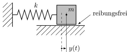
Wir bezeichnen mit  $m$  die Masse, mit  $k$  die Federkonstante und mit  $y(t)$  die Auslenkung des Körpers aus der Ruhelage. Der Körper werde aus der Ruhelage ausgelenkt und zum
