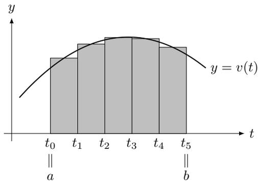
(In dieser Grafik wurde das Intervall  $[a, b]$  in fünf Teilintervalle  $[t_{i-1}, t_i]$  mit  $i = 1, \dots, 5$  unterteilt und der konstante Funktionswert in den Intervallen wurde durch die Auswertung der Funktion  $v(t)$  jeweils in der Mitte der Teilintervalle bestimmt).
