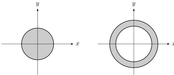
Der Kreis des linken Querschnittes besitzt Radius  $R$ . Im rechten Querschnitt beträgt das Verhältnis zwischen der Wandstärke und dem Aussenradius  $1/4$ . Die Querschnittsfläche links und rechts ist gleich. Man bestimme das Verhältnis der polaren Flächenmomente der beiden Querschnitte.
