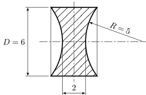
Hier ist  $D = 6$  der Durchmesser der Linse und  $R = 5$  ist der Radius mit welchem die Linse geschliffen wurde. Man bestimme das Volumen der Linse mit Hilfe von Integralrechnung.
